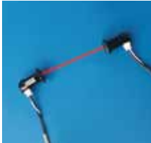
IR photocell beams
